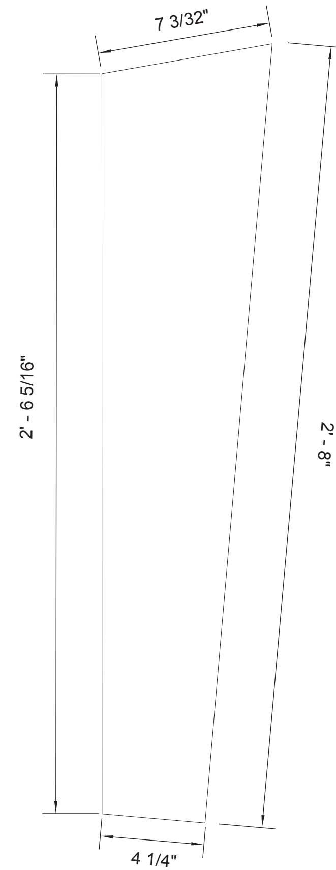
3 WM4 - END CAP ELEVATION SCALE: 3" = 1' - 0"
